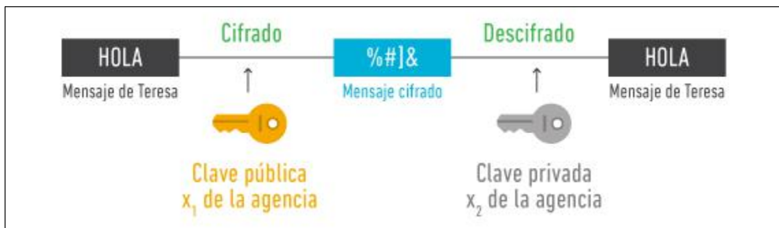
Imagen 31. Proceso de cifrado y descifrado mediante clave pública y clave privada.
