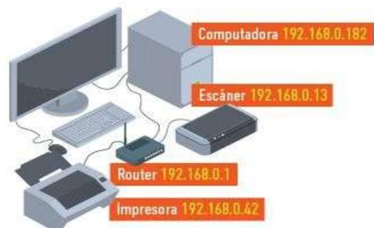
Figura 2. Red hogareña con sus respectivas direcciones IP.
